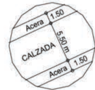
AMPLIACION DETALLE ACCESO VEHICULAR ESCALA 1: 500
