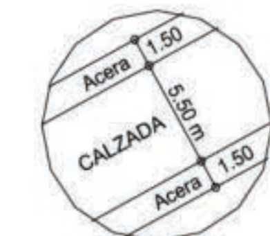
AMPLIACION DETALLE ACCESO VEHICULAR ESCALA 1: 500
